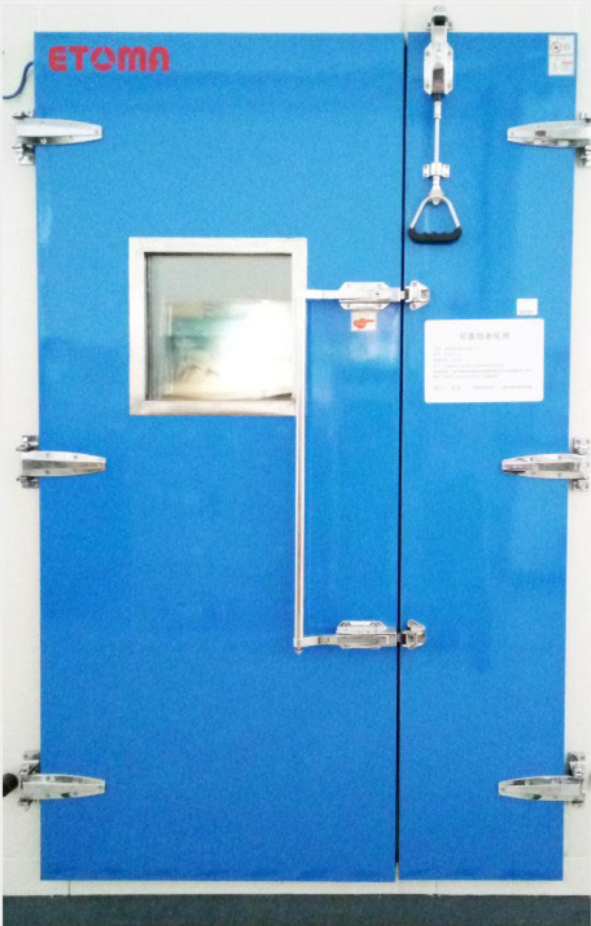
6.大型可靠性老化房（69m³）
