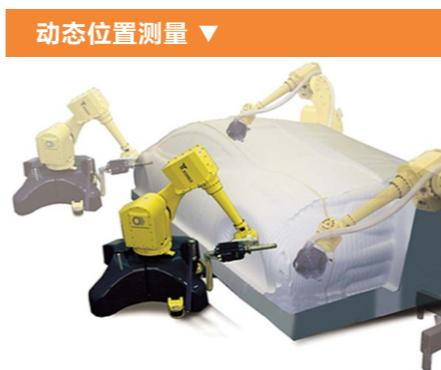
● 三维测量半径:  $20\text{m}$    ● 空间精度： $15\mu\text{m} \pm 6\mu\text{m}/\text{m}$
