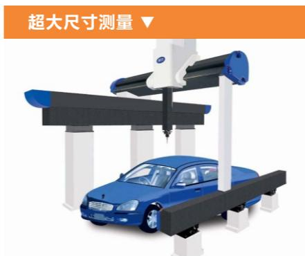
● 测量行程:  $2500\text{mm} \times 5000\text{mm} \times 1500\text{mm}$
